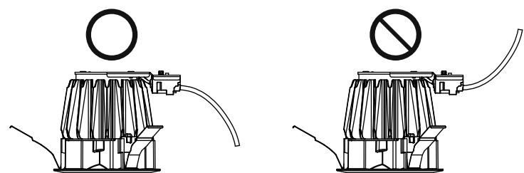
電源線に張力がかからないように上図のように電源端子台より反射板枠側へ向かって折り曲げる。
