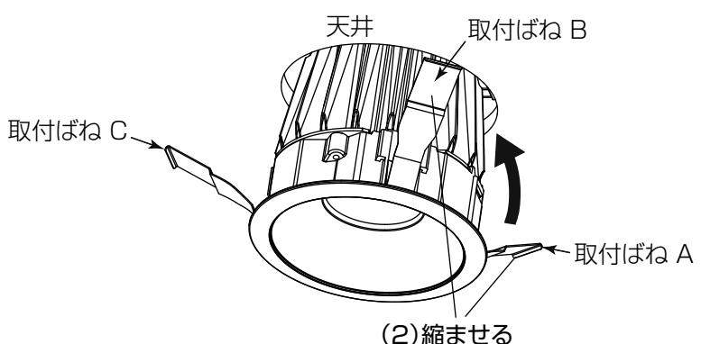
(2) 取付ばねA・Bを矢印の方向へ縮ませ、埋込穴に挿入する。
