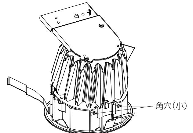
(2) ライトユニットの固定爪を反射板枠の角穴(大)に1ヶ所カチッと音がするまで押し込む。
