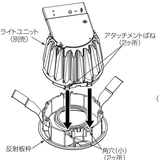
(1) ライトユニットのアタッチメントばねを反射板枠の角穴(小)に2ヶ所引掛ける。
