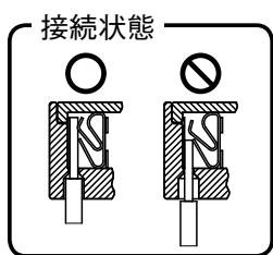
・電源線を電源端子台から取り外すときは、幅6mmのマイナスドライバー等で、解除ボタンを押しながら電源線を引き抜く。
