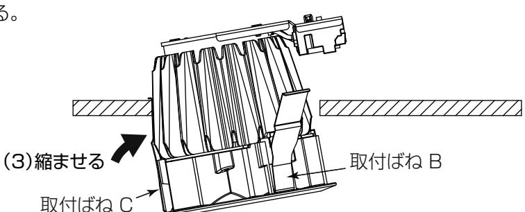
(3) 取付ばねCを縮ませ、埋込穴に挿入する。
